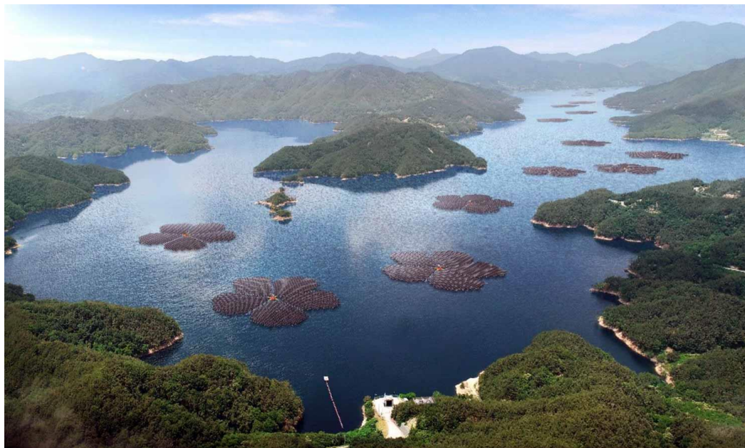
Рис.4. Плавучая фотоэлектрическая (ФЭ) электростанция мощностью 41 МВт будет установлена на плотине Хапчон в Южной Корее
